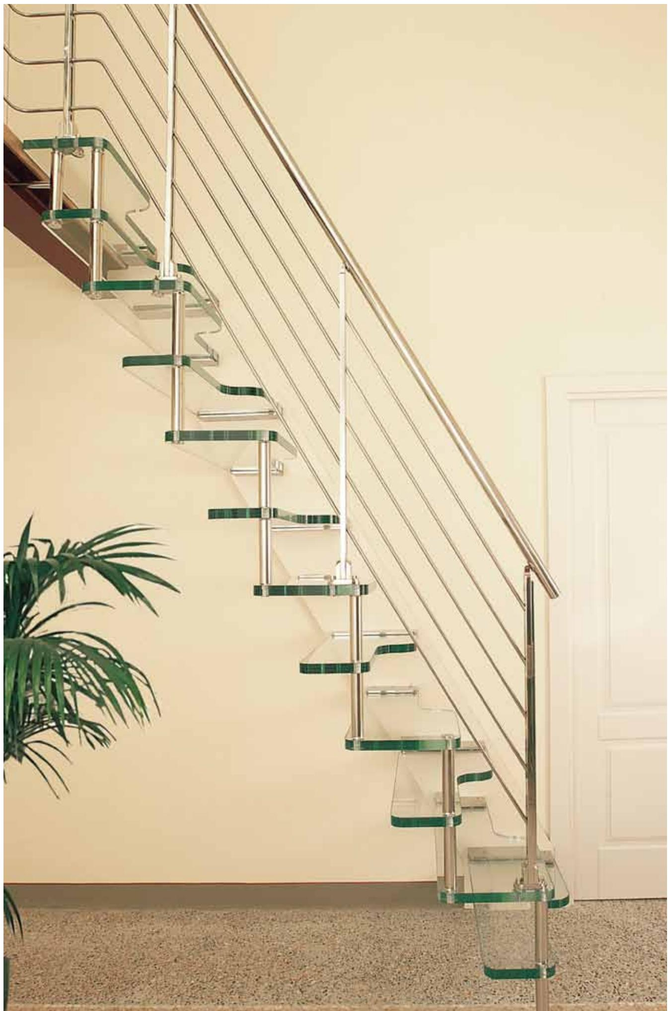
Scala a sbalzo a giorno alla marinara in cristallo strutturale extrachiaro con struttura laterale in ferro verniciato e ringhiera a tondini orizzontali in acciaio inox.
